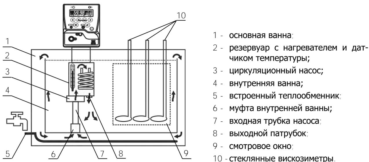
Рисунок 2 — Принцип работы термостата
