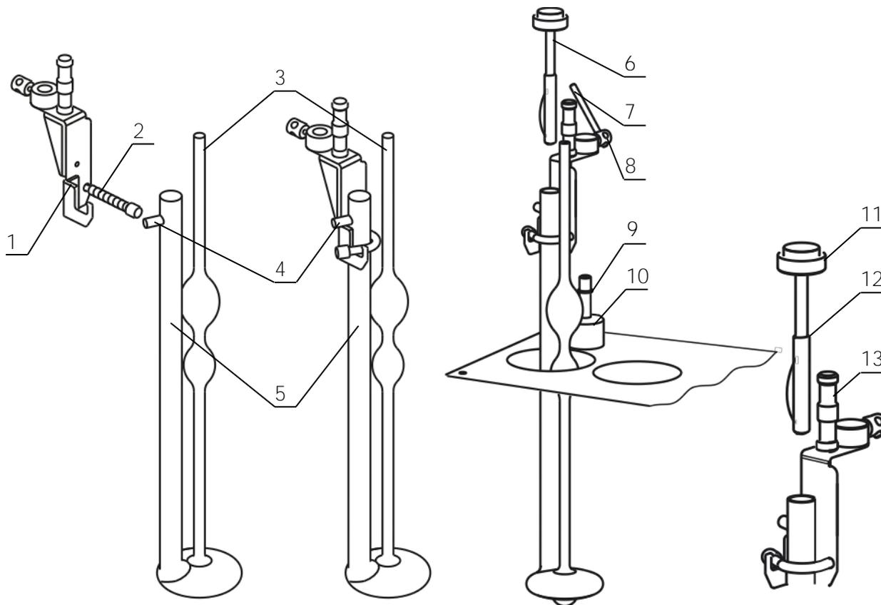
Рисунок 5 — Установка вискозиметров
